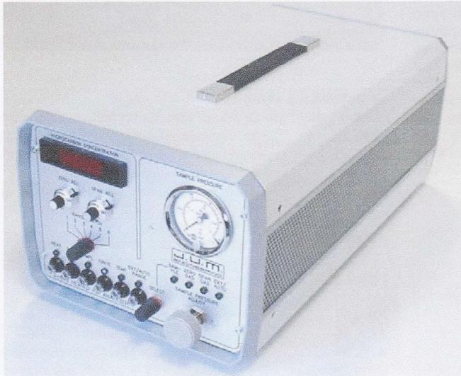
**Die Gesamt-C Baugruppe ist kompatibel mit der 2.BlmSchV, 13.BlmSchV, 17.BlmSchV, und TA Luft (DE), Kompatibel mit EN 13526 und EN 12619 (EU), sowie EPA Methode 25A und Methode 503 (USA)**
